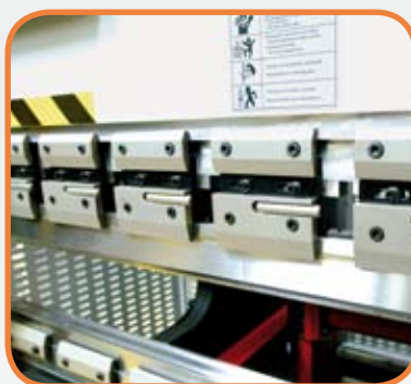
Dettaglio bloccaggio punzone Attacco utensile con intermediari Standard intermediate with manual blocking
