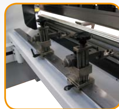
Registro posteriore con due riscontri Back gauge with two fingers
