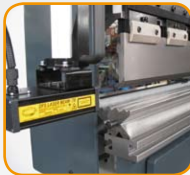
Dettaglio bloccaggio punzone anche con attacchi Amada Standard intermediate also with Amada type
