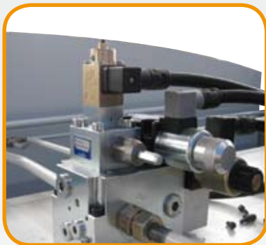
Idrulica Hoerbiger con valvole proporzionali Hydraulic Hoerbiger with proportional valves
