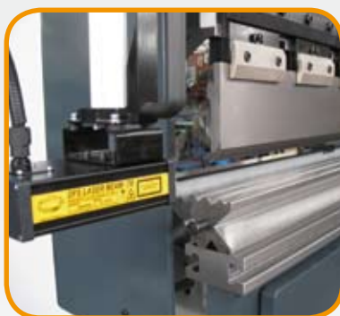
Dettaglio bloccaggio punzone anche con attacchi Amada Standard intermediate also with Amada type
