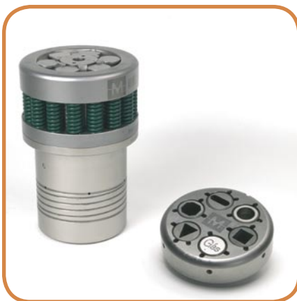
Multitool a 6 utensili Ø Max 24 mm
